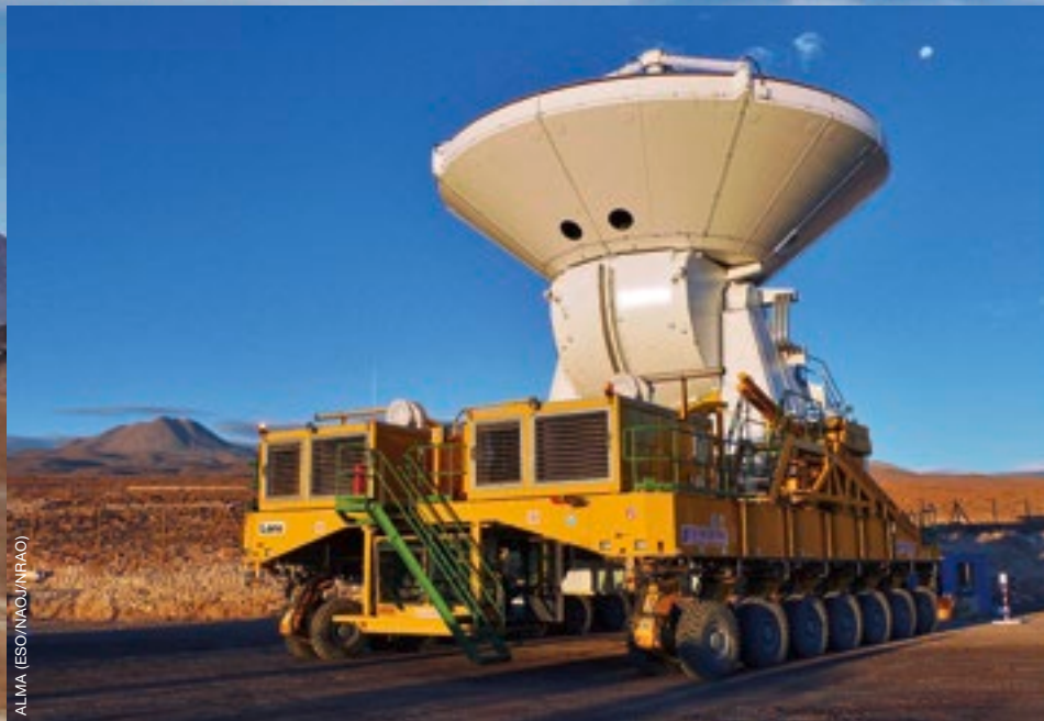
Sadan tonnin painoista eurooppalaista ALMA-antennia kuljetetaan Lorella, yhdellä valtavista ALMA-kuljetusalustoista, toimintojen tukikeskuksesta Chilen Andeilla.
